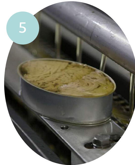
Adición de líquido de cobertura: aceite de oliva.
