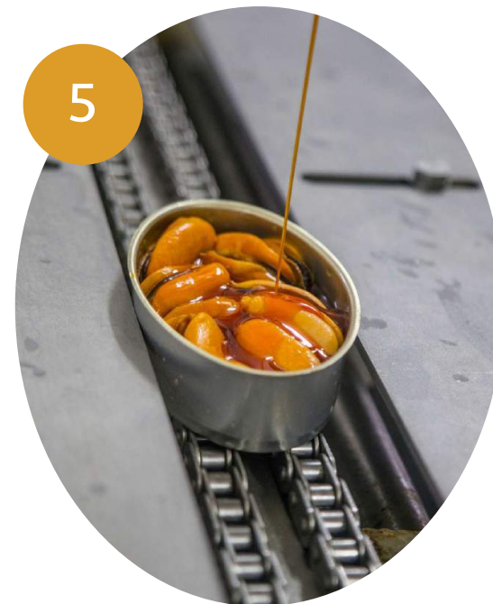
Adición de líquido de cobertura: escabeche.
