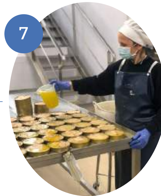
Adición del líquido de cobertura: aceite de oliva.
